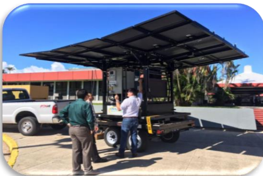
UPRH recibe máquina desalinizadora y purificadora de agua Donada por Los Padres Foundation, organización sin fines de lucro. La máquina opera con tecnología solar.
