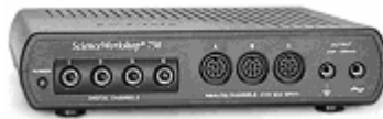
Figura 16 Los dos terminales de la salida del generador, o “batería”, están en el extremo derecho
