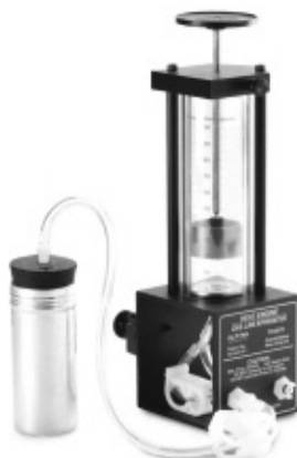
Figura 1 Aparato para verificar la ley de Charles
