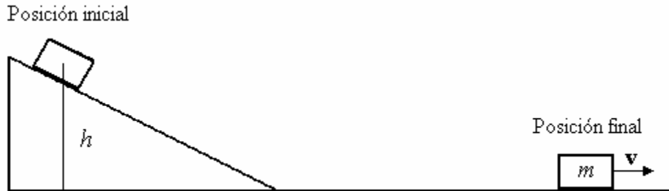
Figura 1 Un bloque se desliza sin fricción por un plano inclinado, a partir del reposo
