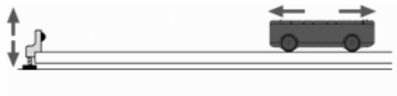
Figura 1. Riel nivelado. El carro debe permanecer en reposo
